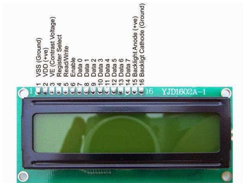
Рис. 2.12. Виводи LCD 1602
