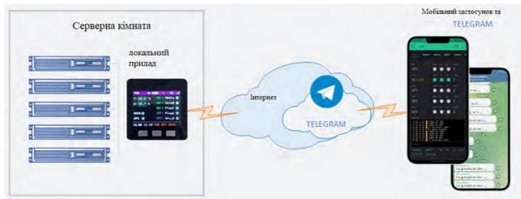
Рис. 1.12. Система SNMP моніторингу мікроклімату серверної кімнати
