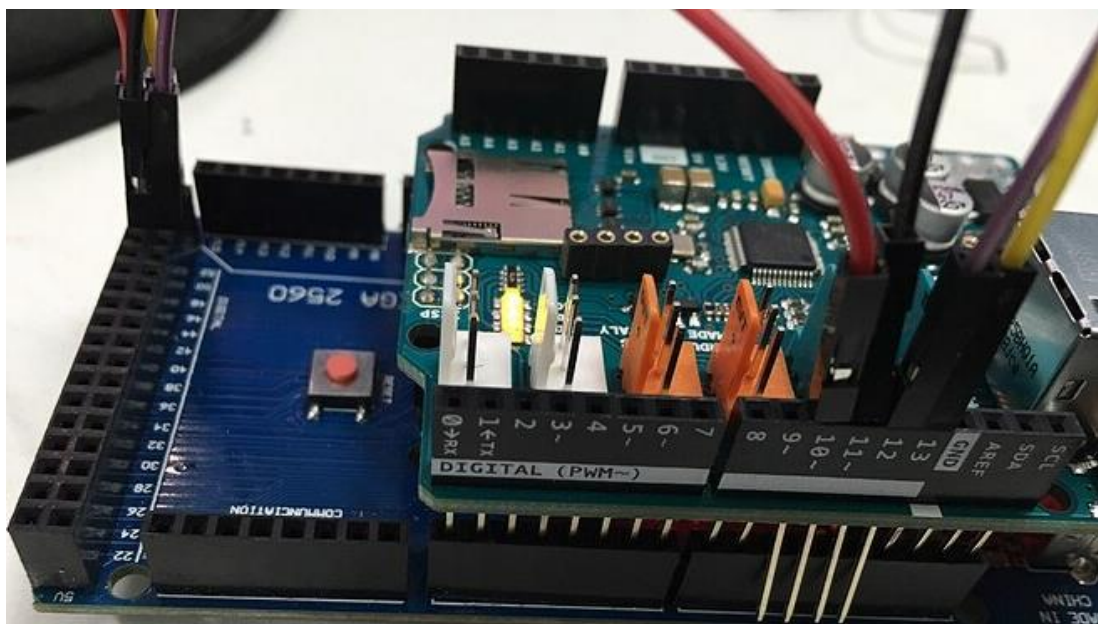
Рис. 3.18. Схема підключення модуля Ethernet Shield W5100
