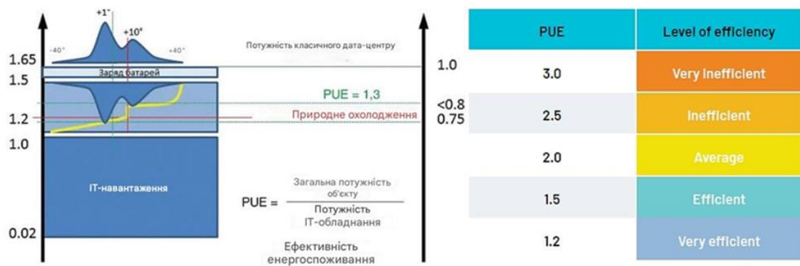
Рис. 1.3. Концепція визначення оптимального рівня PUE (Power Usage Effectiveness)
